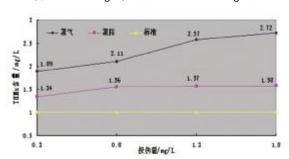
水厂消毒一般在清水池进行,通常氯投加在过滤之 后,当原水水质较差时或为抑制沉淀池和滤池中藻类的 生长, 在加混凝剂的同时加氯, 以氧化水中的有机物 (预氯化)。当供水管网很长,管网末梢的余氯难以保证 时,需要在管网中途补充加氯,这样既保证管网末梢的 余氯,又不致使水厂附近管网中的余氯过高,中途加氯 位置一般都在增压泵或水库站内。二次加氯池采用氯气 消毒,前期管网已经有一定的消毒副产物,再次加氯很 容易使消毒副产物超标。 (三水厂 穆凯传 张格维)
